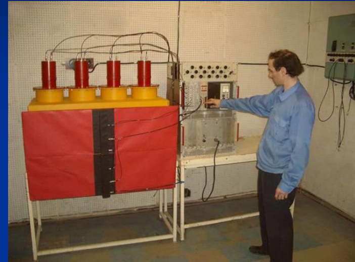
Черенковский водяной счетчик Фронтальная площадь - 0.5 \text{ м}^2 Объем – 250 л 4 ФЭУ R5912 Hamamatsu (Япония)
