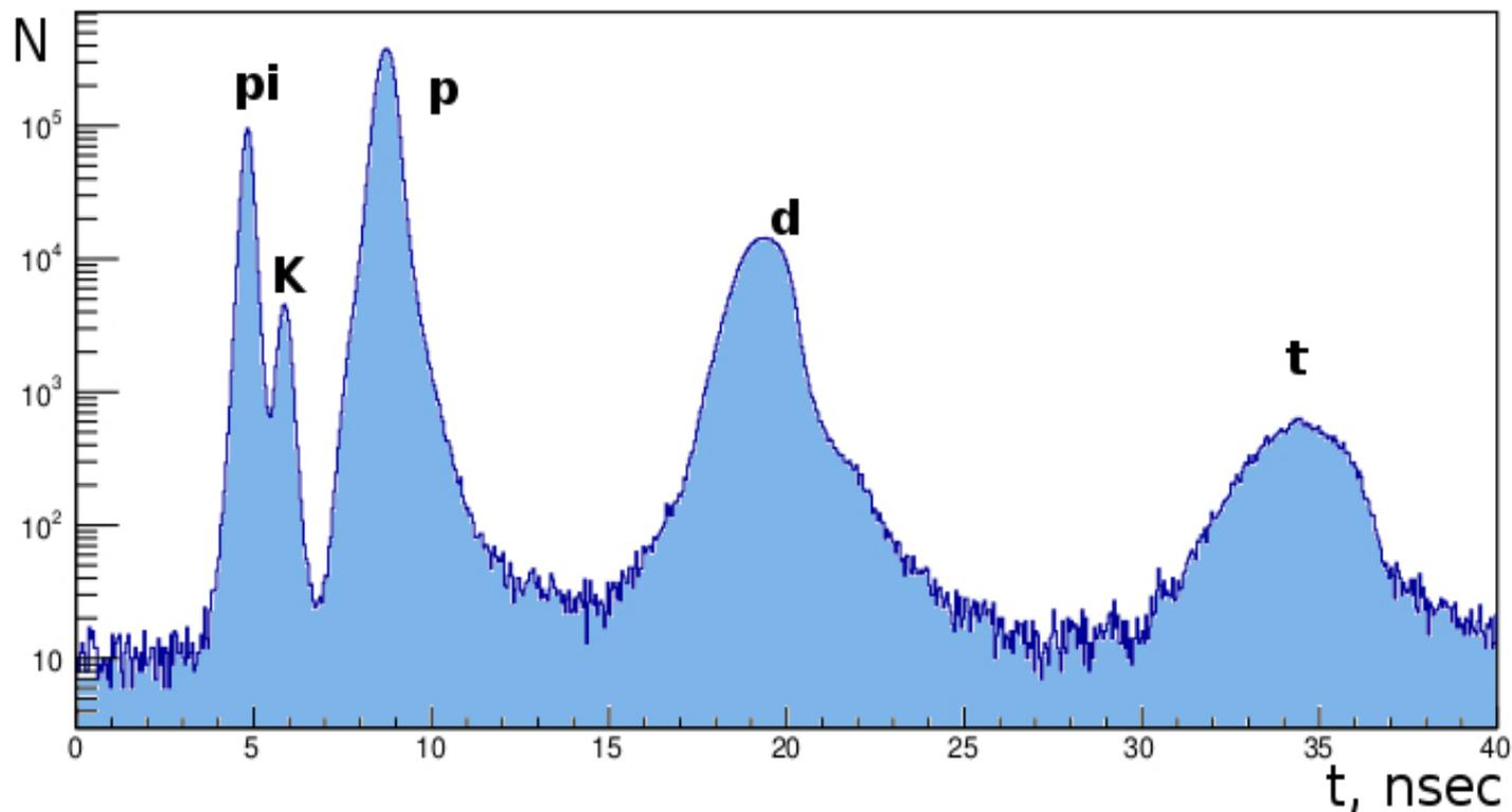
пример сырых данных TOF для h<sup>+</sup> при импульсе 2.4 GeV/c
