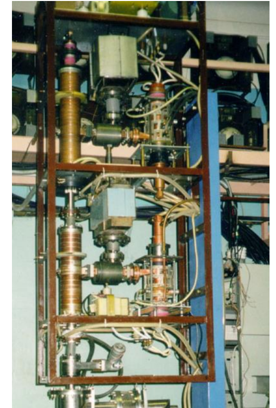
Линейный ускоритель электронов непрерывного действия 1.2 МэВ/60 кВт. 2001
