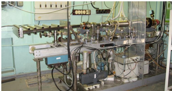
Импульсный линейный ускоритель для радиационных технологий на энергию 10 МэВ. Совместно с ФГУП «НПП «Торий», 2007
