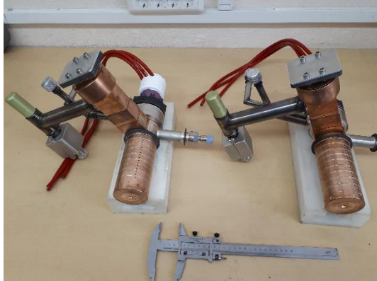
Ускоряющие системы С-диапазона на энергию 6 МэВ
