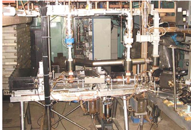
Импульсный разрезной микротрон на энергию 35 МэВ с большой яркостью пучка с инъекцией от СВЧ пушки с фотокатодом. Для World Physics Technologies Inc. USA, 2004
