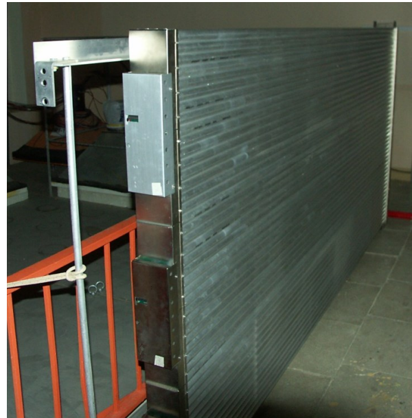
Дрейфовая камера (3520×1460×210 мм)
