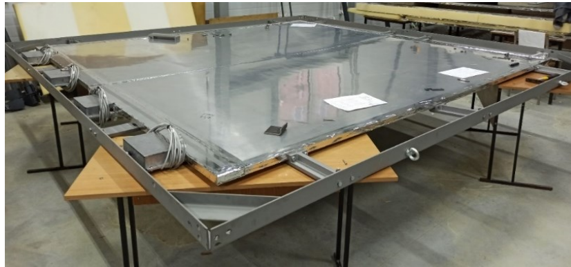
Собранная однопроекционная плоскость ССД
