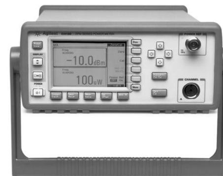
Основные приборы для комплектации измерительного стенда – измеритель параметров СВЧ цепей E5071C-280 и измеритель мощности HP-Agilent EPM442A фирмы Agilent Technologies
