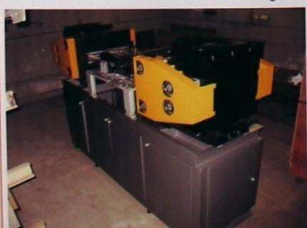
Разрезной микротрон PAM-55 на энергию 55 МэВ
