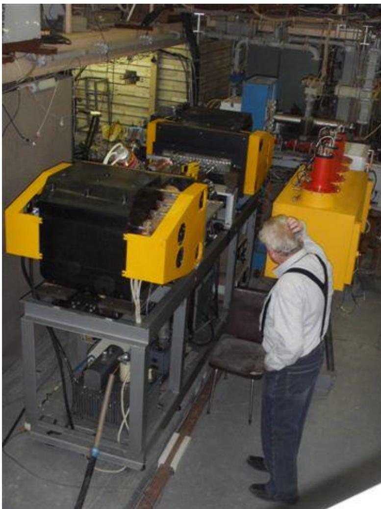
Рис. 5. Прототип фотоядерного детектора СВВ.
