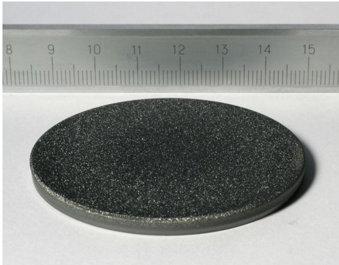
Фотография выращенной алмазной пленки на подложке кремния диаметром 57 мм .
