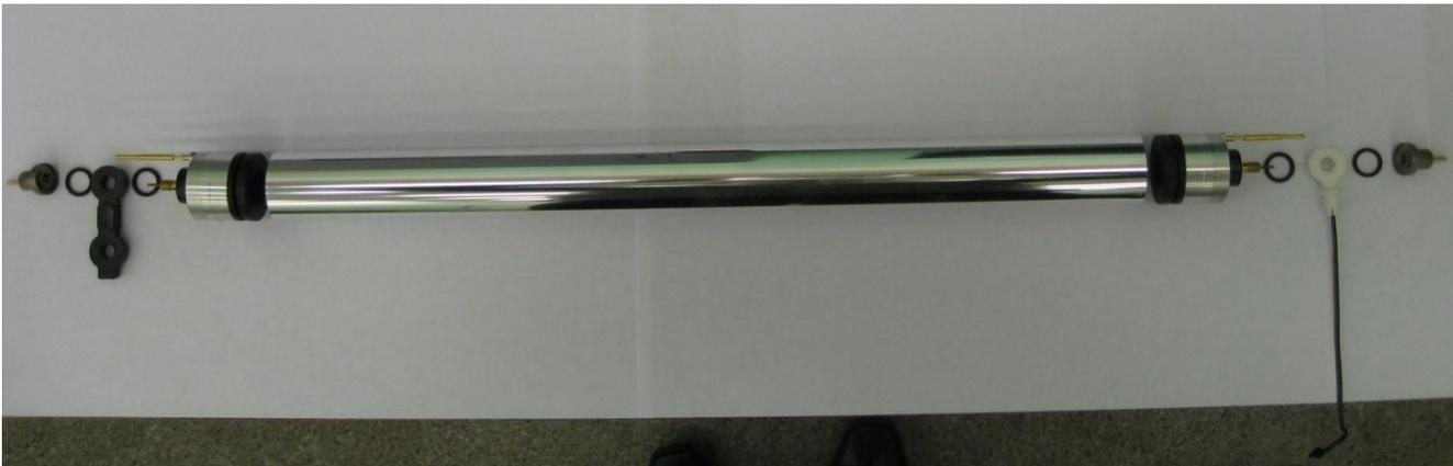
**Рис.4. Фотография майларовой дрейфовой трубки.**
