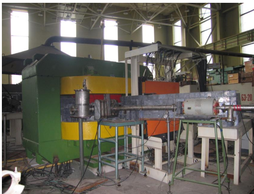
Экспериментальный зал №1: конечная часть электронного тракта (с квадрупольной линзой и пропорциональной камерой), подводящего электронный пучок высокой энергии к цилиндрическому вакуумному боксу, предназначенному для установки мишени на гониометре и рентгеновской детектирующей аппаратуры (лето 2012 г.)
