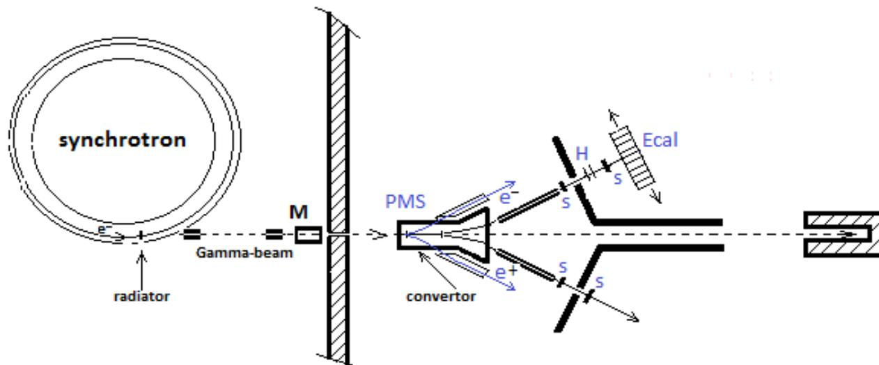
Схема расположения калибровочных каналов на основе парного магнитного спектрометра на основе СП-57 (ПМС)
